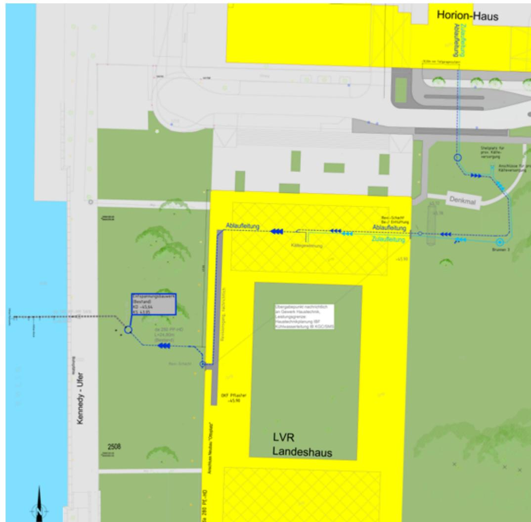
Bild 11 – Verlauf der Ablaufleitungen der Grundwasser-Kälteversorgung des Landes- und Horion-Hauses.
